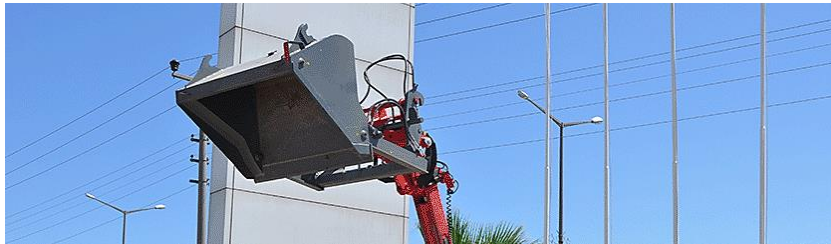
バケット容量0.71m 3 、幅1400mm
