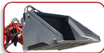
バケット容量0.71m 3 、幅1400mm
