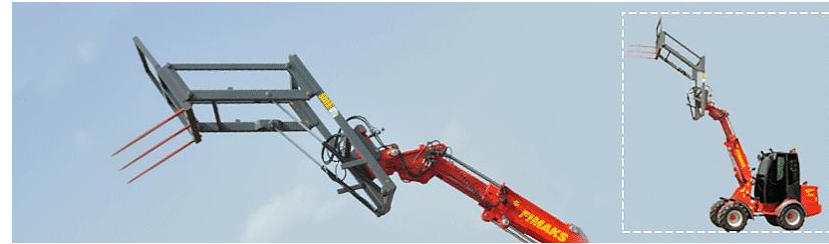
最大作業高5.5m 最大揚力1000kg
