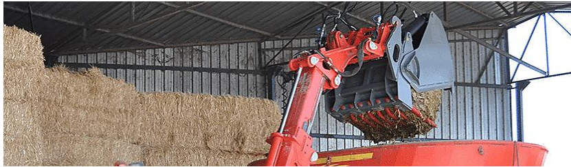
作業機寸法 940×800×750mm
