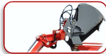
作業機寸法 940×800×750mm
