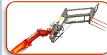
最大作業高5.5m 最大揚力1000kg
