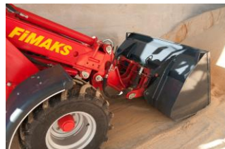
バケット容量0.8m 3 、幅1600mm
