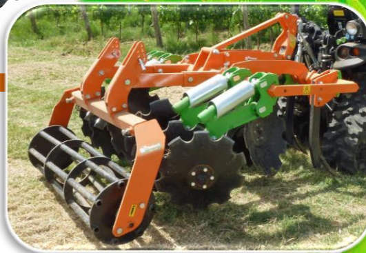
●ストーンジャンパー ディスクに障害物が当たると スプリングにより持ち上がり ショックを吸収します。スプリ ングはディスクにバイブレーション 効果ももたらし土塊を砕きます。
