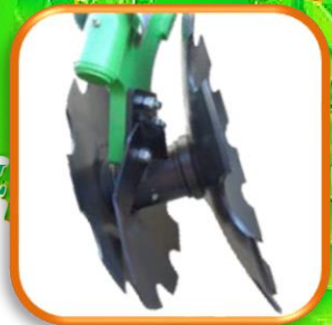
●ダブルディスク φ51cmとφ61cmの異なる径の組合せが耕起の効率を向上させます。
