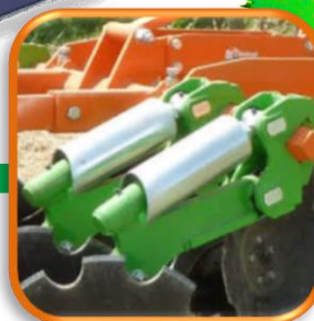
●ストーンジャンパー ディスクに障害物が当たるとスプリングにより持ち上がりショックを吸収します。スプリングはディスクにパイプレーション効果ももたらし土塊を砕きます。
