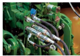
油圧シャッターコントロール チェックバルブ付（複動2系統）
