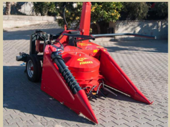
日本仕様：台風等による倒伏時用に、サイドオーガーを標準装備
